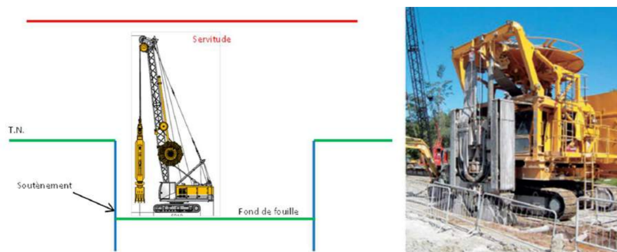
Schéma de réalisation des parois moulées avec fouille préalable et machine compacte (source : BAUER)
